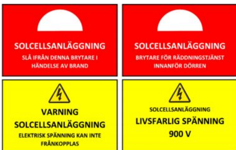
Figur 3. Skyltning för brytare och spänningsförande delar (Räddningstjänsten Storgöteborg, 2019).
